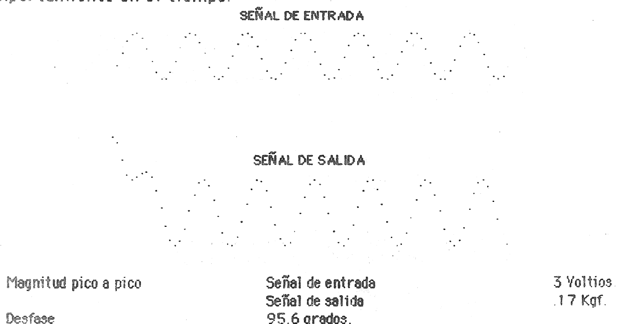
FIGURA 11. Simulación de la respuesta a 1.4 Hertz
